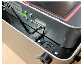
Inbusschraube am Boden der Steuerung entfernen.
