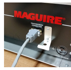
Zapojte kabel základny pro vzdálenou montáž do řídicí jednotky na mísiči.
