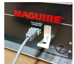
Sluit kabel van houder voor externe montage aan op WSB-controller.
