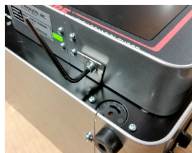
Draai de inbusbout aan onderkant van touchscreen los.
