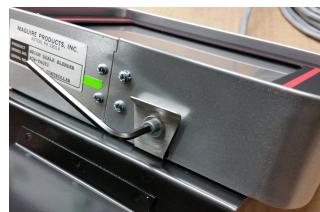
Plaats touchscreen op houder voor externe montage en draai inbusbout vast.
