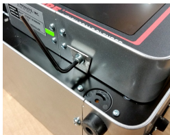
Wykręcić śrubę imbusową u podstawy sterownika.
