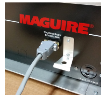
Przymocować przewód podstawy montażowej do montażu wyniesionego do sterownika mieszalnika.
