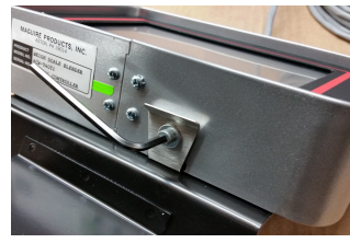
Agganciare il controller alla base di montaggio remoto e fissare il bullone Allen al controller.
