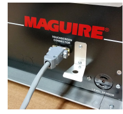
Fissare il cavo della base di montaggio remoto al controller del miscelatore.
