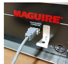
Fixez le câble du support de montage à distance au contrôleur.
