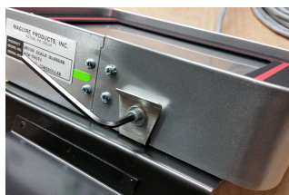
Suspendez le contrôleur sur le support de montage à distance et serrez la vis à six pans sur le contrôleur.
