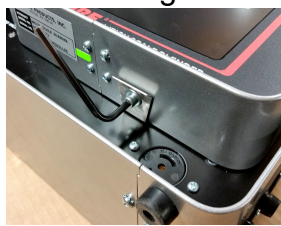
Retirez la vis à six pans à la base du contrôleur.
