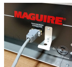
Asegure el cable de la base de montaje remoto al controlador del mezclador.
