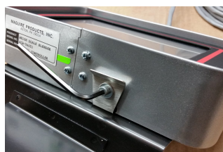
Coloque el controlador en la base de montaje remoto y fije el perno Allen al controlador.
