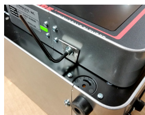
Retire el perno Allen de la base del controlador.
